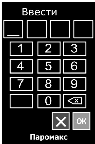
**Окно ввода PIN-кода для блокировки/разблокировки панели управления.**
