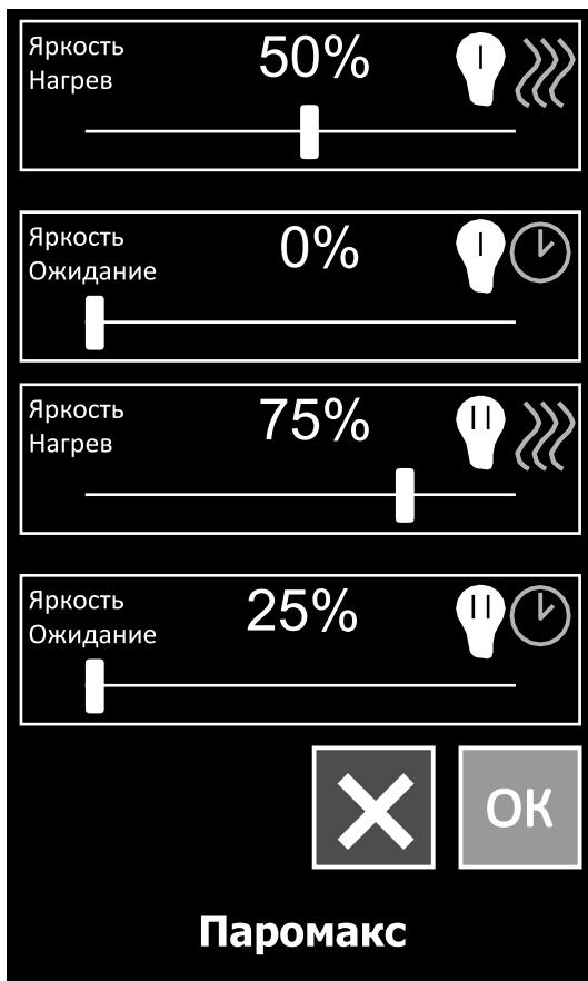
**Яркость освещения 1 в режиме нагрева.** С помощью бегунка выбрать яркость освещения во время работы печи.
