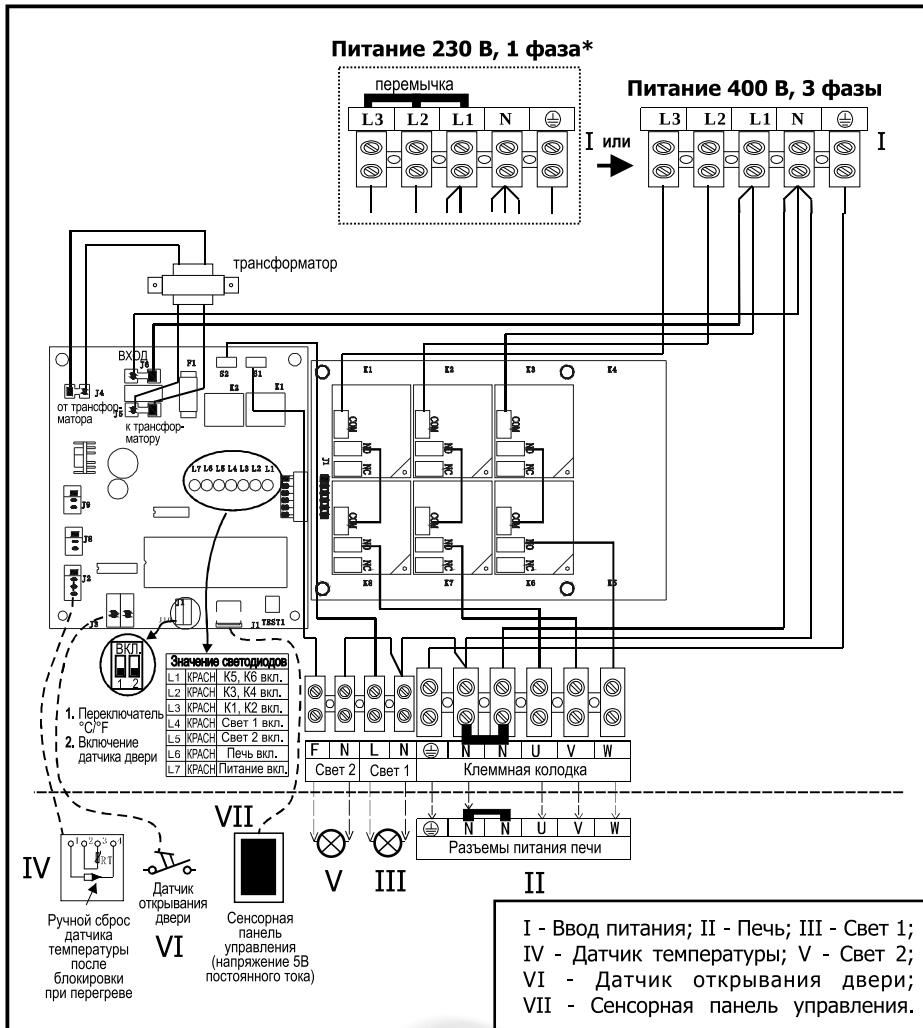
\*При однофазном подключении перемычки ставятся на входную клемму L1 L2 L3. Запрещается ставить перемычки на входе U V W питания печи!
